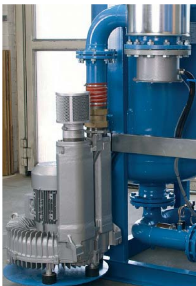
Figure: Detail „Ventilation Unit“
